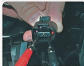
F.2.1 - Procedimento de medida da tensão de alimentação do sensor CMP.
