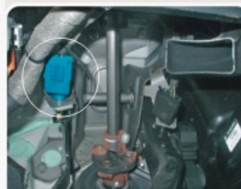
Localização do sensor CPP: fixado no pedal de embreagem.
