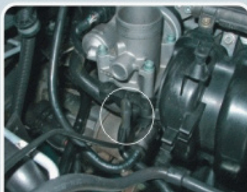
Mangueira de vapores da CANP
