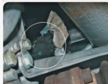
Localização do sensor de velocidade VSS
