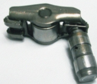
Balancim roletado, que compõem o novo sistema de acionamento das válvulas denominado RSH.
