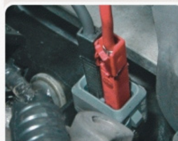
F.1.1 - Procedimento de medida da resistência elétrica do eletroinjetor.
