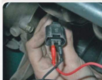
F.2.1 - Procedimento de medida da tensão de alimentação do sensor CKP.
