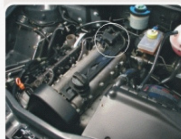
Localização da bobina de ignição.
