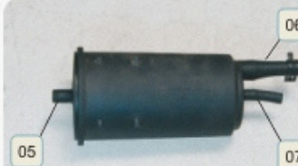
Canister - Filtro de carvão ativado responsável pela absorção de vapores de combustível evitando a poluição atmosférica.
