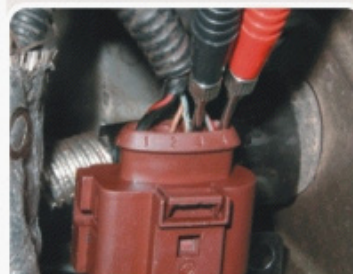
F1.1 - Medida da tensão de resposta do sensor HEGO.
