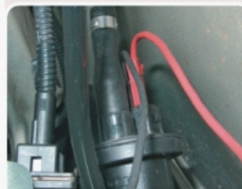
F.3.4 - Aplicação da tensão da bateria na CANP.
