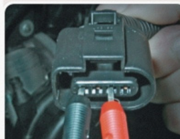
F.3.1 - Procedimento de medida da tensão de alimentação do sensor CMD.
