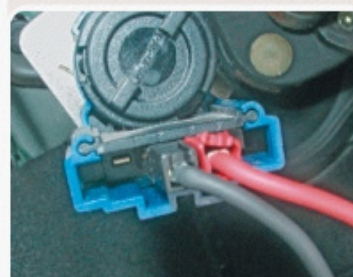
F.2.1 - Medida da resistência no próprio sensor.
