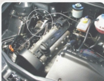
Localização da borboleta motorizada (ETC).
