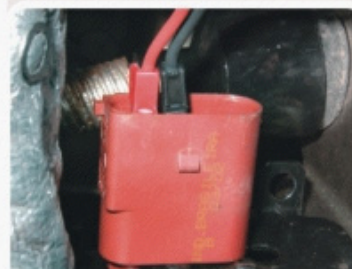
F3.1 - Medida da resistência de aquecimento do sensor HEGO.
