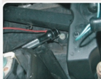
F.1.1 - Batida no sensor KS com uma haste metálica.
