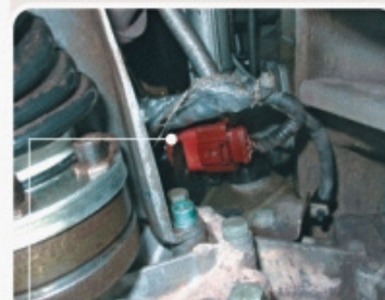
Localização do terminal elétrico do sensor HEGO.
