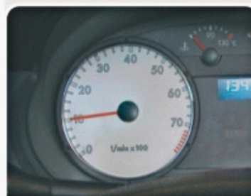
F.1.1 - Medida da rotação do veículo.
