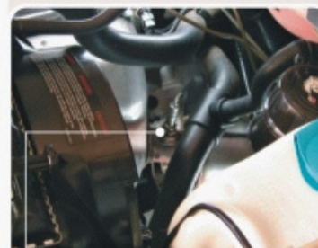
Localização do sensor HEGO: no tubo de descarga próximo ao catalisador.
