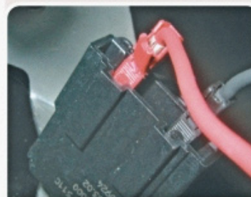
F.2.1 - Medição da resistência no próprio sensor.
