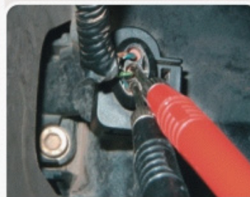
F.1.2 - Procedimento de medida da frequência do sinal do sensor CKP.
