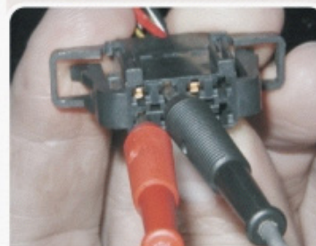
F.2.1 - Medida da tensão de alimentação do potenciômetro 1 do sensor SPA.
