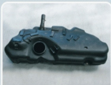
Vista superior do tanque de combustível
