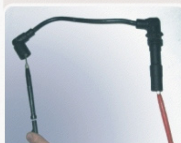
F.4.1 - Procedimento de medição da resistência do cabo de vela.
