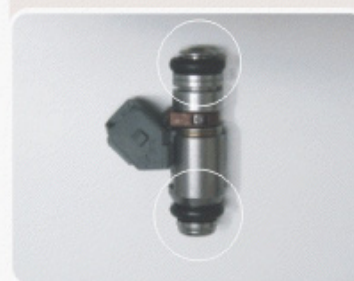
F.4.5 - Inspeção do anel O'ring.
