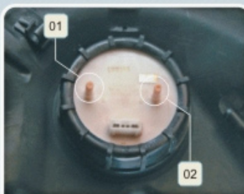
Dutos da bomba de combustível
