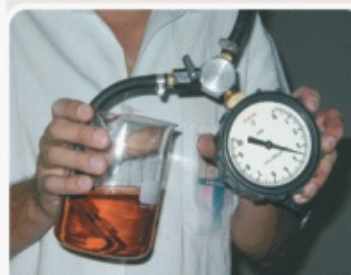
F.1.4 - Abertura da válvula estranguladora até que a pressão caia para 3,5[bar].
