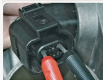
F2.1 - Medida da tensão de alimentação dos potenciômetros do ETC.
