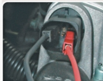
F3.1 - Medida da resistência elétrica do potenciômetro 1 do ETC.
