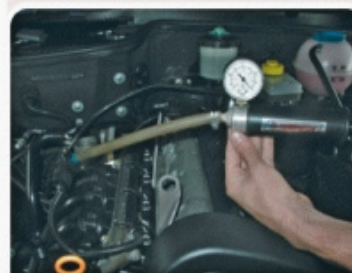
F5.1 - Bomba de vácuo conectada ao CMD.
