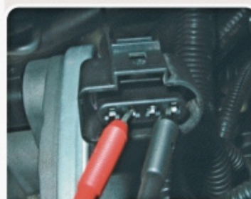
F.3.2 - Procedimento de medida da tensão de alimentação da bobina de ignição.
