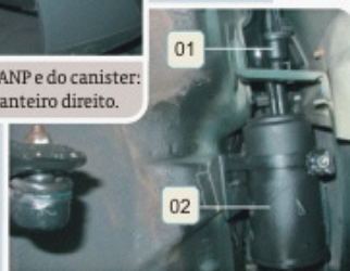
Detalhe da localização da válvula CANP e do canister
