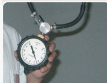
F2.b - Manômetro instalado na linha de pressão.
