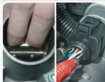
F.1.3 - Medida da tensão de resposta do potenciômetro 1 com a borboleta aceleradora aberta.
