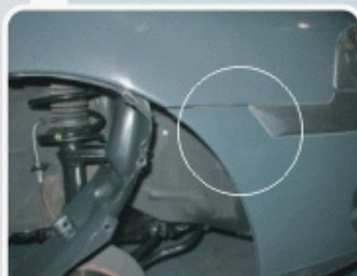
Localização da válvula CANP e do canister: dentro do paralamas dianteiro direito.
