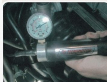
F.1.3 - Bomba de pressão instalada.
