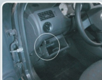
Localização da caixa de relés e fusíveis
