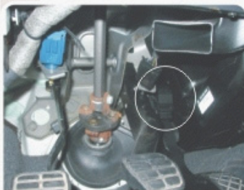
Localização do Sensor de posição do pedal do acelerador (SPA)
