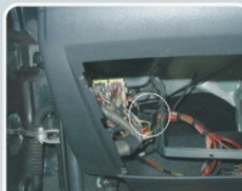
Localização dos relés do eletroventilador do radiador.
