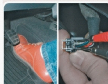
F.1.3 - Medida da tensão de resposta do potenciômetro 1 com o pedal do acelerador pressionado.
