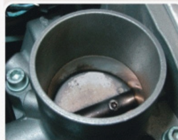
F1.4 - Borboleta aceleradora em sua posição de descanso (abertura de 18°).
