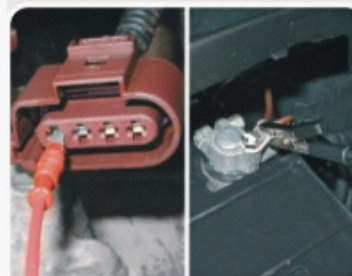
F2.2 - Medida da tensão de alimentação do sensor HEGO.
