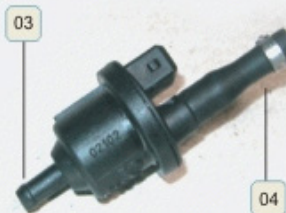
Eletroválvula de purga do canister: é utilizada para controlar a vazão de vapor de combustível para o coletor de admissão.
