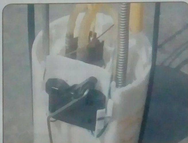
Eletrobomba de combustível
