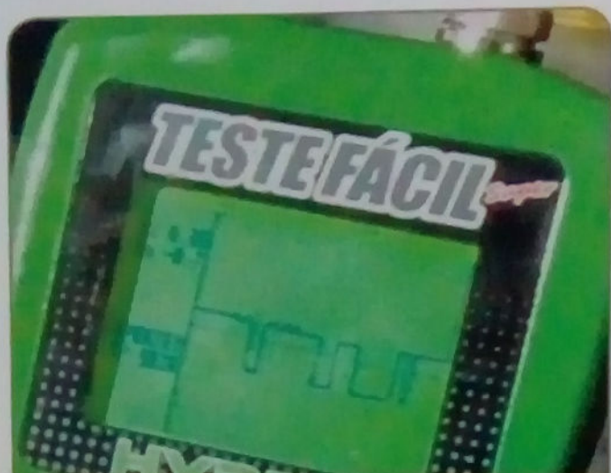
Leitura do sensor de fase com teste fácil
