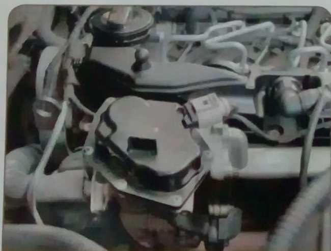
Válvula EGR e radiador dos gases de escape (EURO 3)
