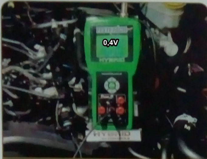
Leitura de tensão com pressão do rail
