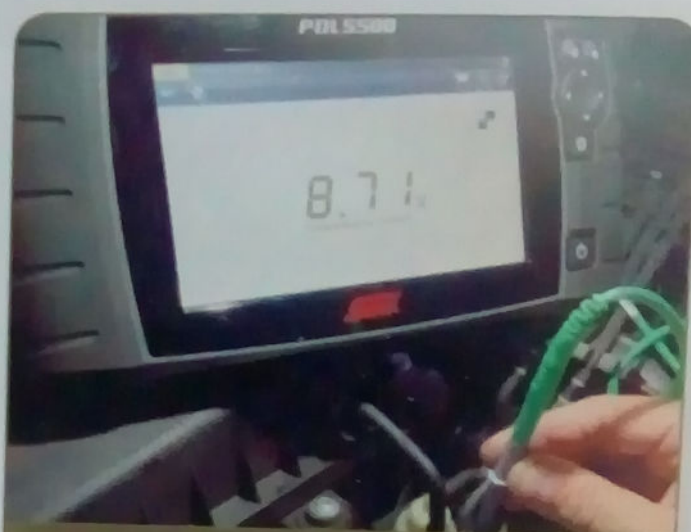
Fio preto – tensão de referência da concentração de oxigênio externo
