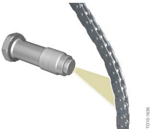
Motor N20, tensor de corrente com bocal de pulverização de óleo para corrente de distribuição
