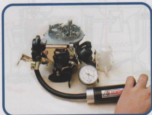
Depressão aplicada na cápsula pneumática desafogadora
