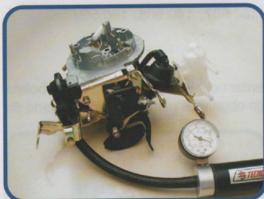
Depressão aplicada na cápsula pneumática desafogadora
