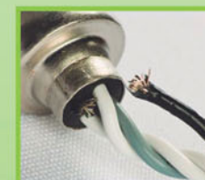
Ruptura de fio por torção
