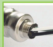
Danos a borracha seladora (Grommet)
