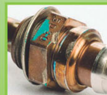
Uso de Ferramenta inadequada
