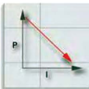
Válvulas de controle de pressão com curva característica de diminuição de pressão N92, N93, N282 e N283
