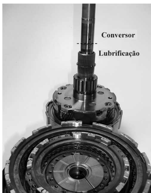
Bucha do estator da bomba é crítica
