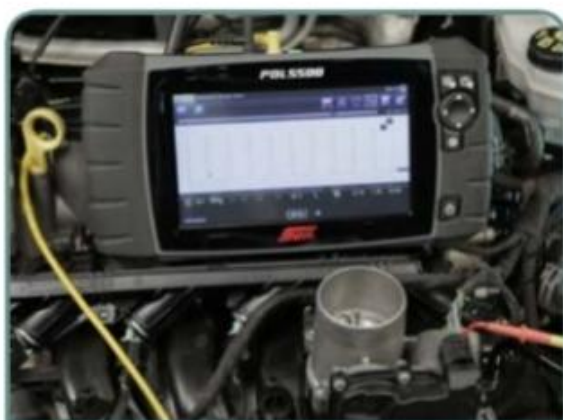
Observe na tela o aparelho a forma de onda gerada
