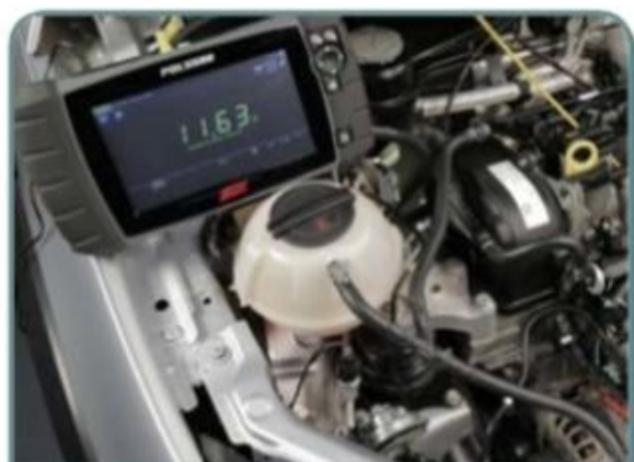
Observe que ao dar a partida no veículo o valor deve ser interrompido
