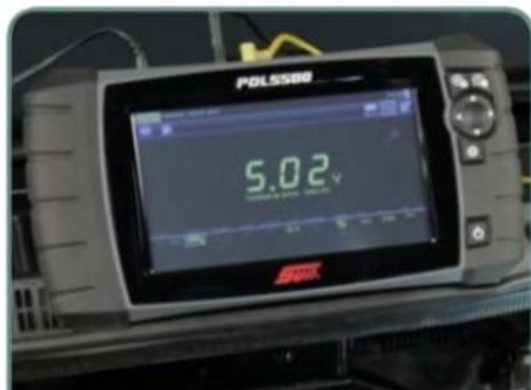
O valor encontrado deve ser em torno de 5 volts
