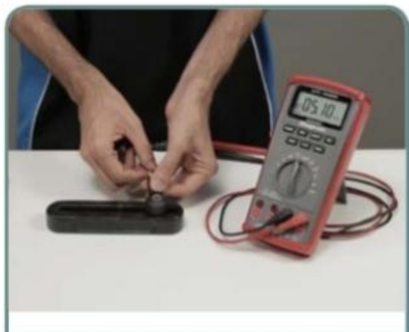
A resistência do sensor deve ser de 5 M ohms
