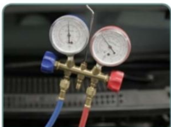
4,5 Bar na Baixa - 8 Bar na Alta Sistema em repouso
