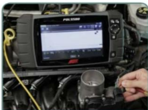
Meça no pino 5 o sinal de gerenciamento eletrônico do motor DC da borboleta
