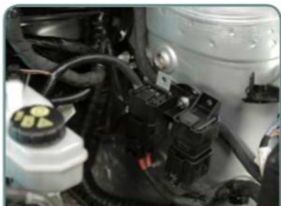
Relés suplementares de aquecimento do combustível
