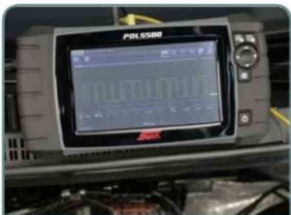
Na tela do aparelho podemos observar a forma de onda gerada pelo sensor
