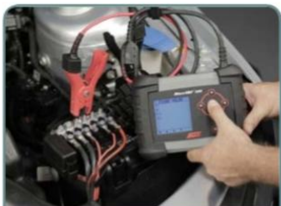
Iniciando teste de bateria
