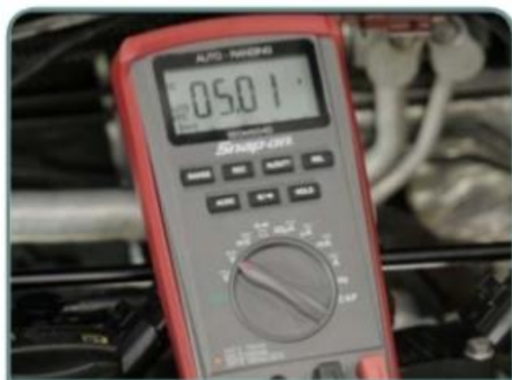
O valor de tensão deve ser em torno de 5 volts
