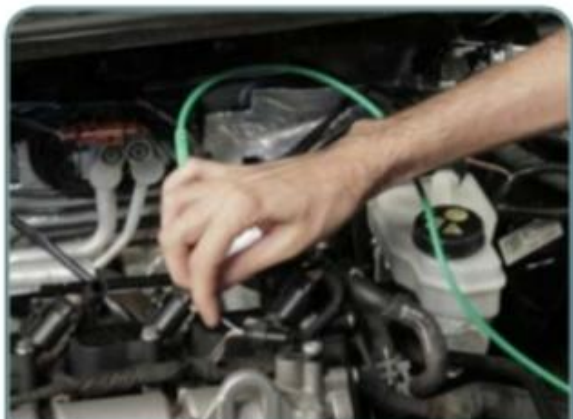
Utilizando o segundo canal do osciloscópio, meça no pino 2 do sensor de fase
