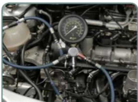
Manômetro conectado a linha de distribuição de combustível
