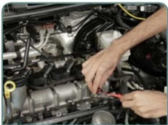
Com o conector removido, meça o valor de tensão no pino 1 de cada injetor
