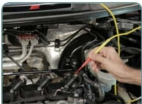
Meça no pino 2 os pulsos de atuação de cada bobina
