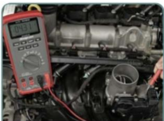
O valor de sinal do sensor 1 fica em torno de 4 volts com o pedal acionado
