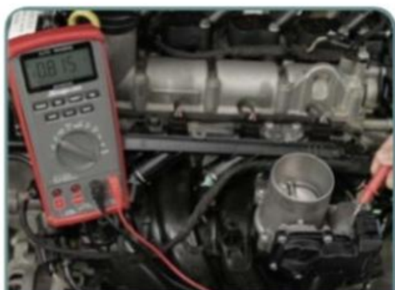
O valor de sinal do sensor 1 fica em torno de 0,8 volt com o pedal livre
