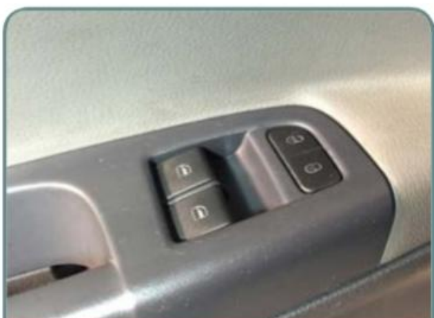
Interruptor dos vidros elétricos
