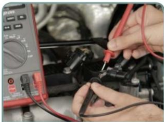
Meça nos pinos 1 e 3 o valor de tensão do sensor de fase
