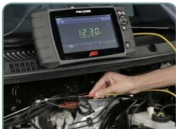
Teste de alimentação da sonda pós catalisador
