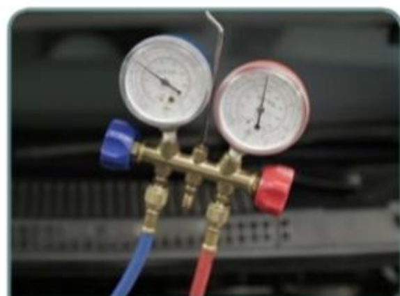
2,5 Bar na Baixa - 12 Bar na Alta Sistema ligado
