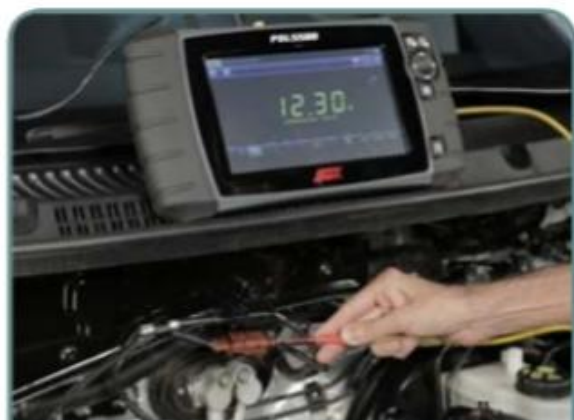
Teste de alimentação da sonda pré catalisador
