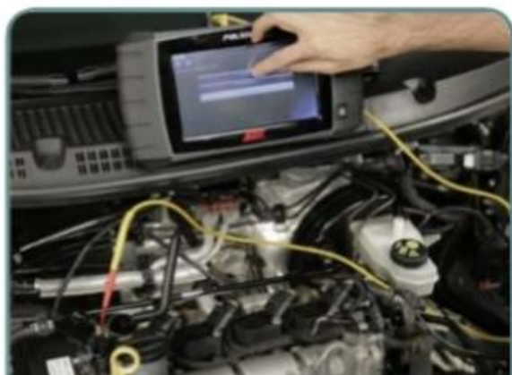
Configure o aparelho para a função osciloscópio
