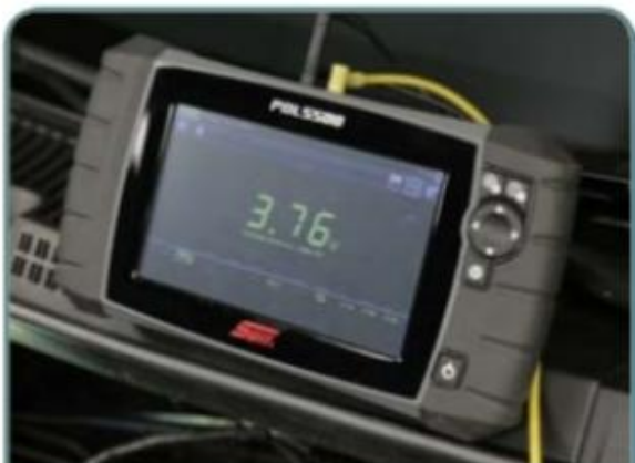
O valor de sinal fica em torno de 3,7 volts com o veículo desligado
