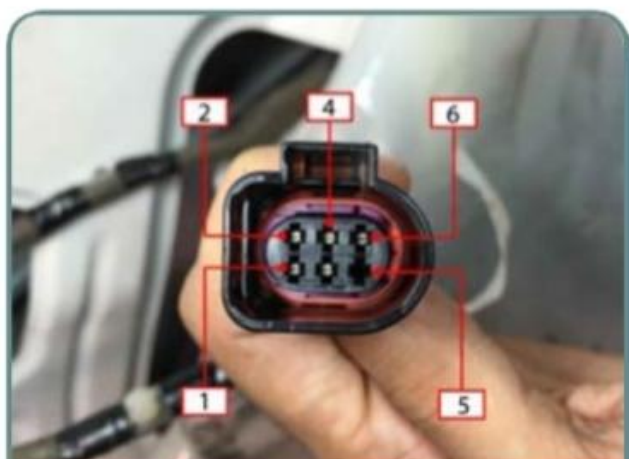
Conector da trava elétrica do motorista
