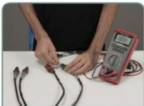
Teste de resistência do aquecedor da sonda pós catalisador
