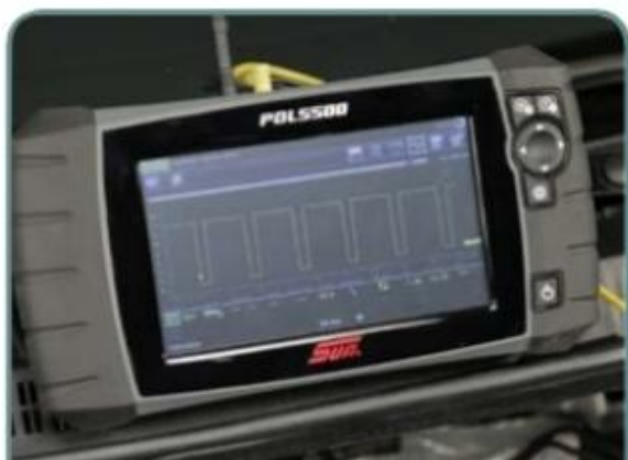
Observe a forma de onda gerada referente ao gerenciamento do solenoide
