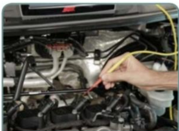
Meça no pino 4 o valor de tensão das bobinas
