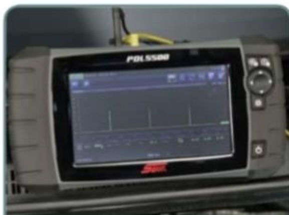
Observe na tela do aparelho a forma de onda gerada dos pulsos de atuação
