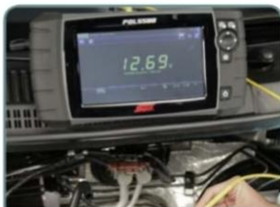
O valor deve ser em torno de 12 volts
