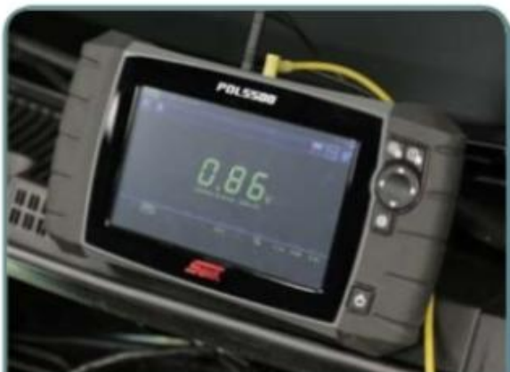
Acelerando o motor a 2000 rpm, o valor cai próximo de 0,8 volt
