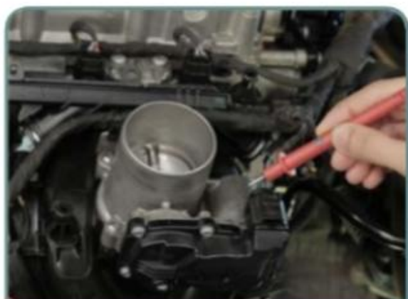
Meça no pino 2 a tensão do sensor
