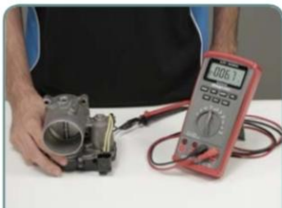
Teste de resistência do enrolamento do motor DC
