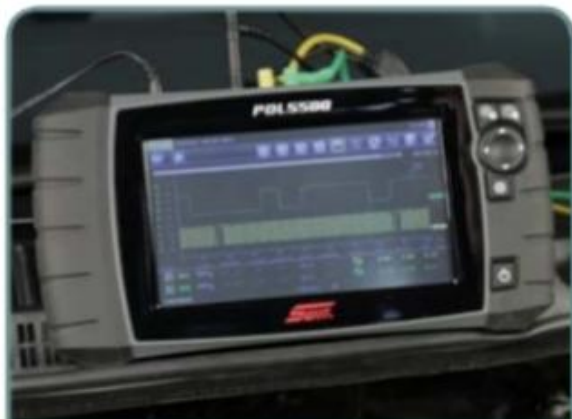
Na tela do aparelho podemos observar o sincronismo do motor através dos sinais do sensor
