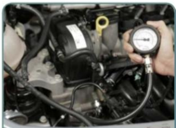
A pressão em marcha lenta deve ser de no mínimo 0,8 bar em marcha lenta
