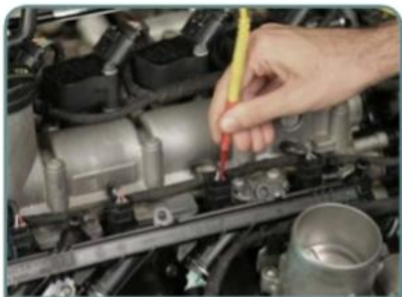
Com o conector inserido meça no pino 1
