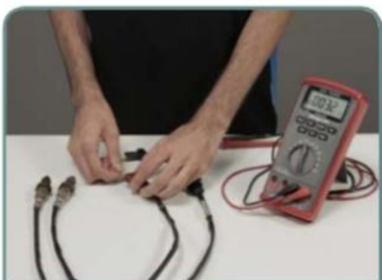
Teste de resistência do aquecedor da sonda pré catalisador
