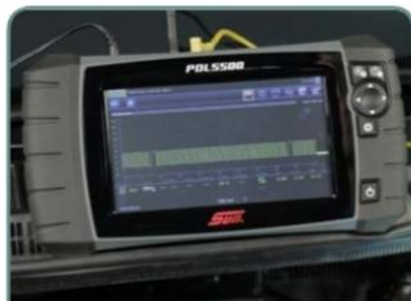
Observe a forma de onda gerada que representa o sinal dos 58 dentes e uma falha
