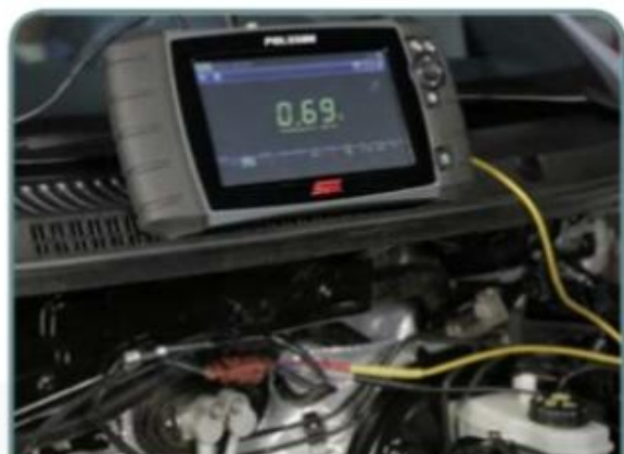
Valor de sinal da sonda pré catalisador
