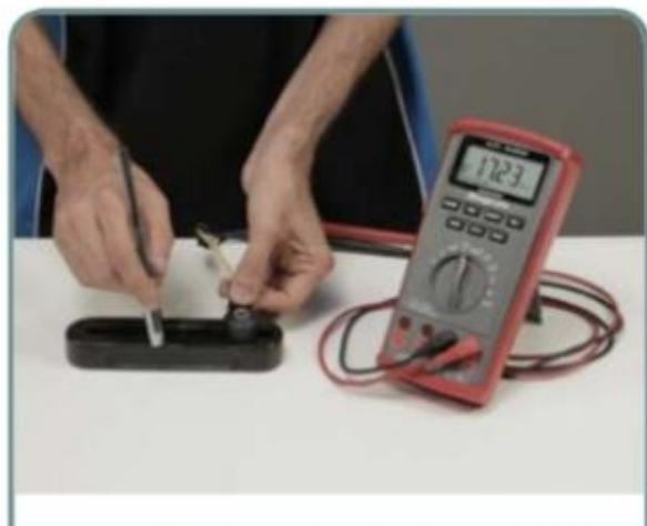
Aplique leves batidas na superfície e observe o sinal de variação
