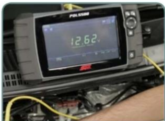
O valor encontrado deve ser em torno de 12 volts
