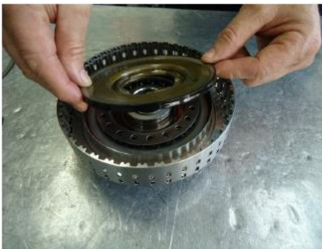
6- Retire na sequência o pistão de compensação, o conjunto das molas de retorno e o pistão de acionamento da embreagem C1.
