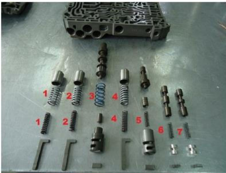
28- Remova todas as válvulas, tampões, molas e travas do corpo de válvulas intermediário, EXATAMENTE como mostram as figuras, e lave todas as peças com um solvente apropriado ou o próprio fluido ATF, secando-as depois com ar comprimido sob baixa pressão (30 psi, 2 bar máximo).
