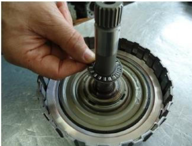
5- Remova o rolamento de apoio da engrenagem solar de saída, conforme mostra a figura.
