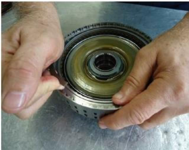
21- Instale o anel trava do conjunto de discos da embreagem C1.
