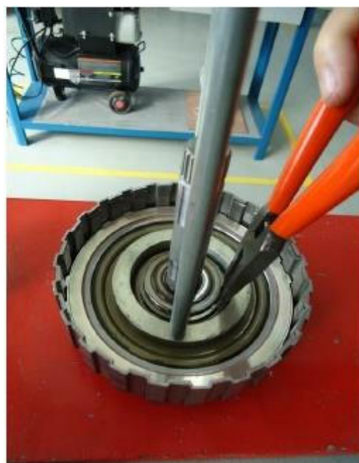
6- Com o auxílio da ferramenta especial, comprima o conjunto das molas de retorno do pistão da embreagem C2.
