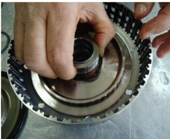
10- Remova os dois anéis de vedação tipo O-ring da carcaça do pistão da embreagem C1 e descarte-os.
