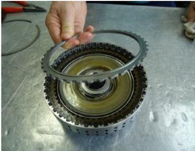
20 - Instale a placa de reação do conjunto de discos da embreagem C1, com seu degrau voltado para cima.
