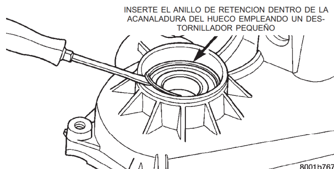
Fig. 44 Instalación de anillo de retención de cojinete delantero del eje transmisor
